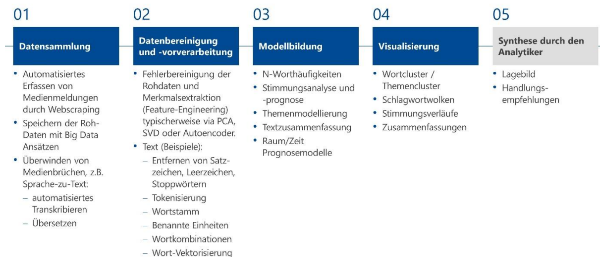
Abbildung 18: Der Prozess des Maschinellen Lernens am Beispiel der Analyse von Social Media Daten mittels NLP, Quelle: Eigene Darstellung.
